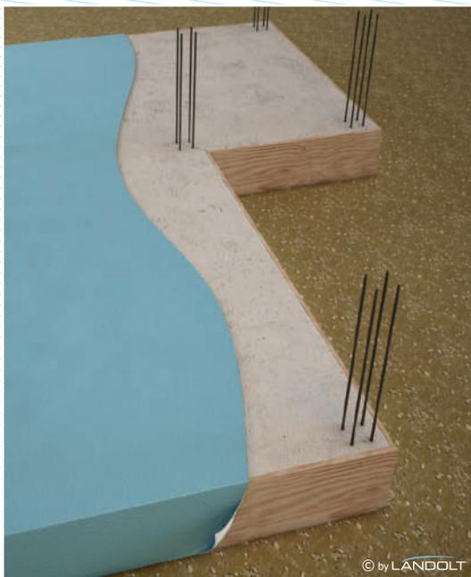
**Froma™ ist eine Frost- und Bautenschutzmatte aus 100% Polypropylen-Stapelfasern, Oberseite mit aufkaschierter hellblauer PE-Folie.**
